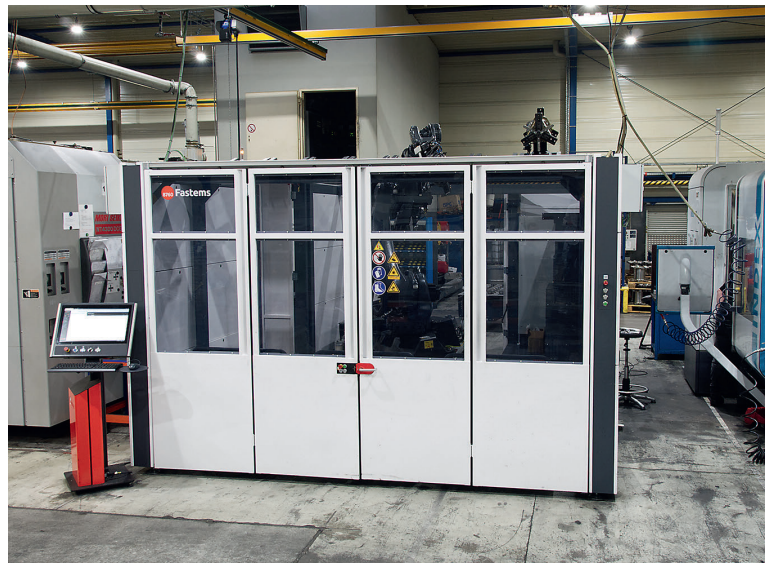
4 Passt selbst in Fertigungsumgebungen mit eng bemessener Produktionsfläche: die RoboCell One mit 6 x 4 m Grundfläche
